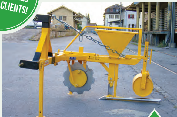
Charrue sous-soleuse permettant de distribuer des appâts contre les campagnols
